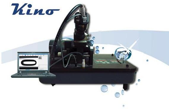
TX500™ 旋转滴超低界面张力仪为美国科诺专业界面张力仪，TX500C 系列是基于美国科诺创新性的可拔插式样品管、整体铝合金块加热系统等技术的经典型旋转滴超低界面张力仪，具有主机独立运行以及软件双重控制功能，操作方便，可分析低至  $10^{-6}$  mN/m 界面张力值，可广泛应用于日化用品、油田三采、微乳、表面活性剂等行业。
