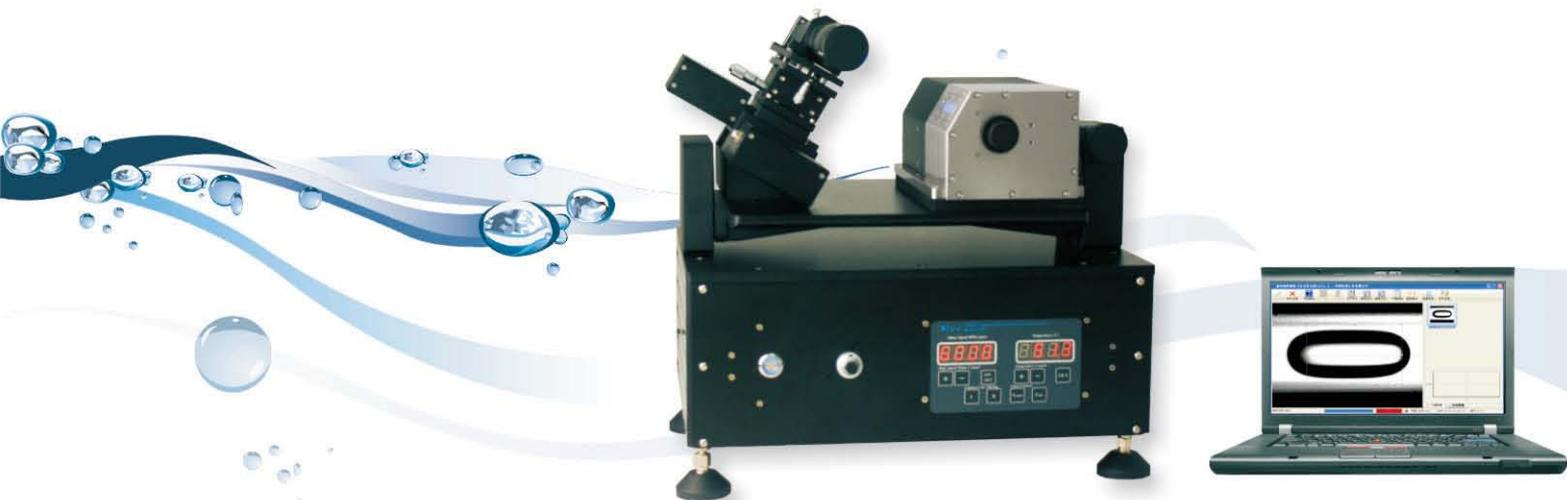
TX500™旋转滴超低界面张力仪为美国科诺专业界面张力仪，Model TX500C系列是基于美国科诺创新性的可拔插式样品管、整体铝合金块加热系统等技术的经典型旋转滴超低界面张力仪，具有主机独立运行以及软件双重控制功能，操作方便，可分析低至 $10^{-6}$ mN/m界面张力值，分析动态界面张力值以及振荡滴、粘弹系数、界面流变、膨胀性质等，可广泛应用于日化用品、油田三采、微乳、表面活性剂等行业。
